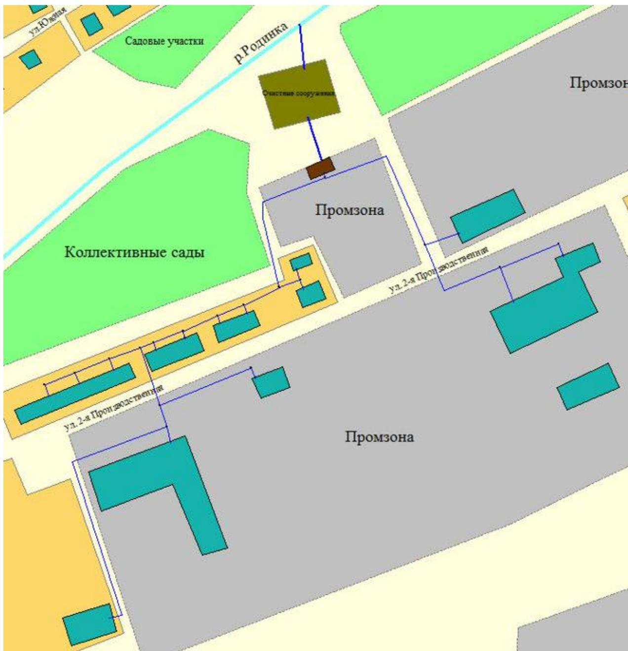
Контур водоотведения на очистные сооружения ОАО «Пучежский сыродельный завод».
