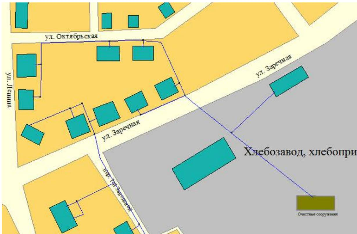
Контур водоотведения на очистные сооружения №2 МУП «Поволжская сетевая компания»
