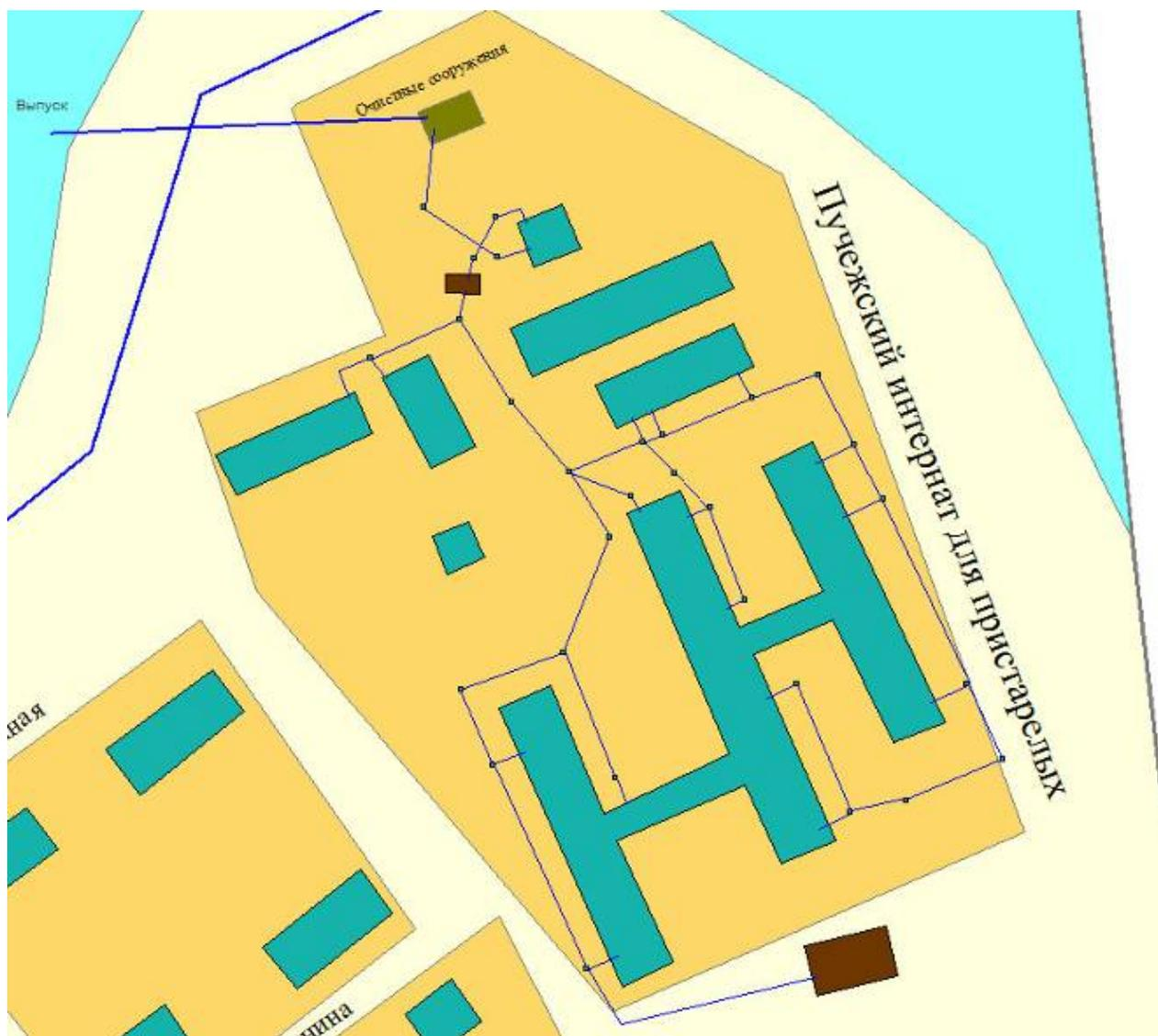
Контур водоотведения на очистные сооружения №1 МУП «Поволжская сетевая компания»
