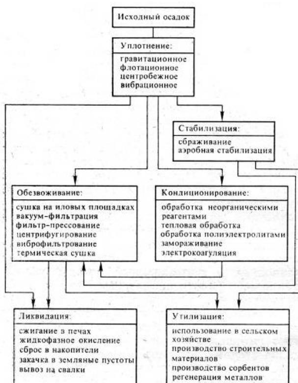
Уплотнение осадков сточных вод является первичной стадией их обработки. Наиболее распространены гравитационный и флотационный методы уплотнения. Гравитационное уплотнение осуществляется в отстойниках-уплотнителях; флотационное - в установках напорной флотации. Применяется также центробежное уплотнение осадков в циклонах и центрифугах. Перспективно вибрационное уплотнение путем фильтрования осадка сточных вод через фильтрующие перегородки или с помощью погруженных в осадок вибраторов.
